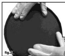
Для обеспечения процедуры замены, поместите устройство на ровной земле перед установкой. Возьмите наждачную бумагу и зафиксируйте ее на диске (см. рис).
